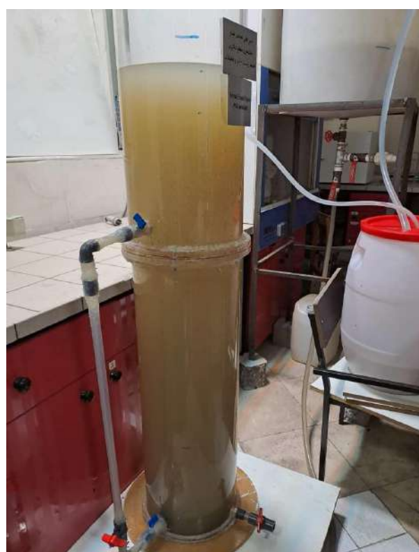
شکل ۱- تصویر شماتیک از راکتور UASB مورد استفاده در این مطالعه
