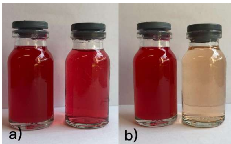
شکل ۷- مقایسه جذب بیولوژیکی و حذف کل رنگ Reactive Red 194 توسط (a) قارچ غیرفعال شده؛ و (b) قارچ زنده Trametes sp.
