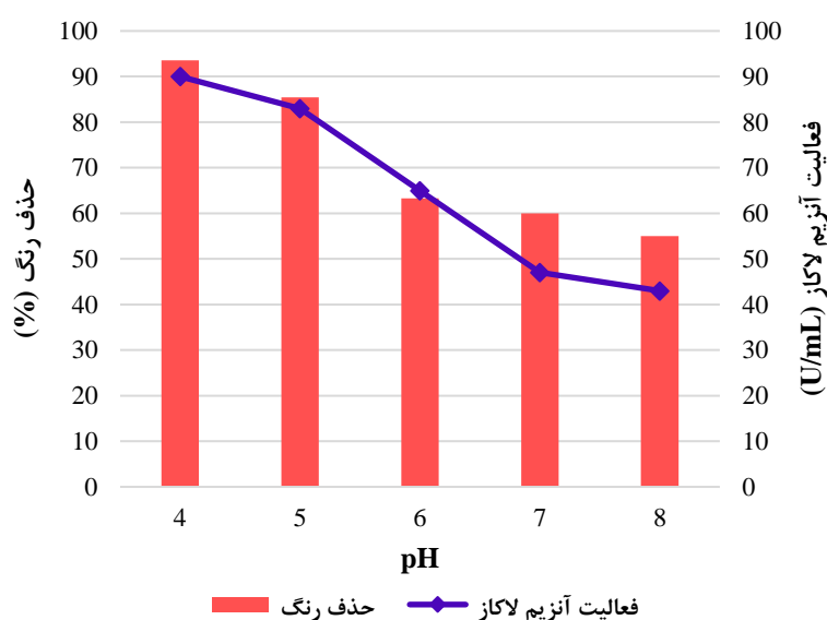
شکل ۳- تاثیر pH بر میزان فعالیت آنزیم لاکاز و رنگ‌بری رنگ Reactive Red 194 توسط Trametes sp.
