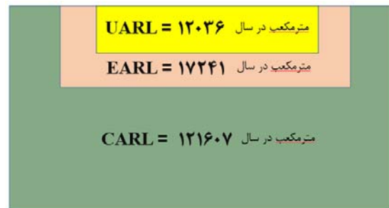
شکل ۵- مقادیر نشت اجتناب‌ناپذیر، سطح اقتصادی نشت و مقدار نشت سالانه موجود در شهر برف‌انبار در منطقه فریدون‌شهر استان اصفهان در سال ۱۳۹۵
