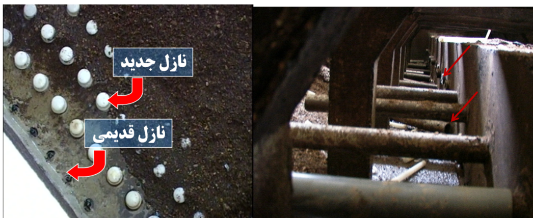
شکل ۳- لوله های توزیع هوای بریده
