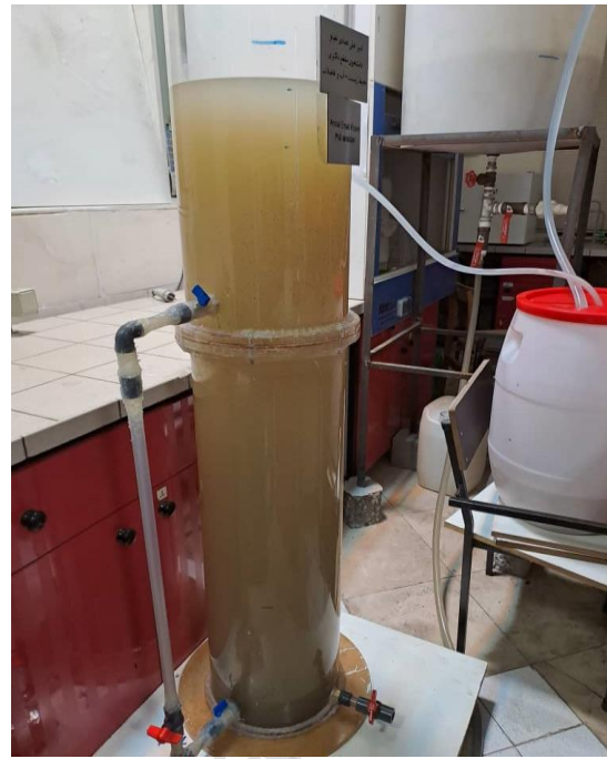
شکل ۱- شماتیکی از راکتور UASB مورد استفاده در این مطالعه
