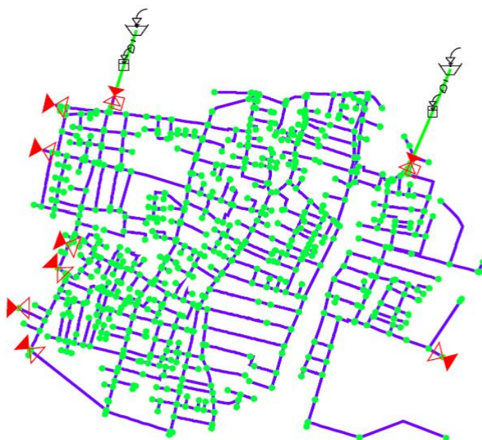
شکل ۱- مدل شبکه آب منطقه مورد مطالعه در نرم‌افزار WaterGEMS
