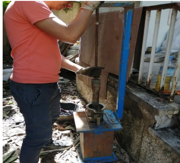
شکل ۲- کوبیدن مخلوط آسفالتی متخلخل به روش مارشال
