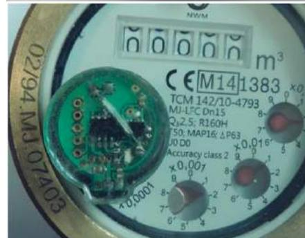
شکل ۱- نمایی از محل نصب پلمپ بر روی کنتور
