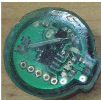
شکل ۲- نمایی از مدار داخلی طراحی شده پلمپ
