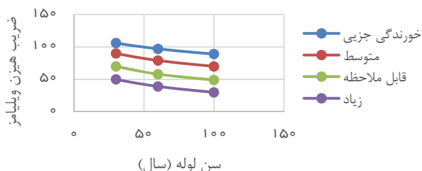
شکل ۵- تأثیر سن لوله و خوردگی آب در قطر ۱۵۰ میلی‌متری روی ضریب زبری
