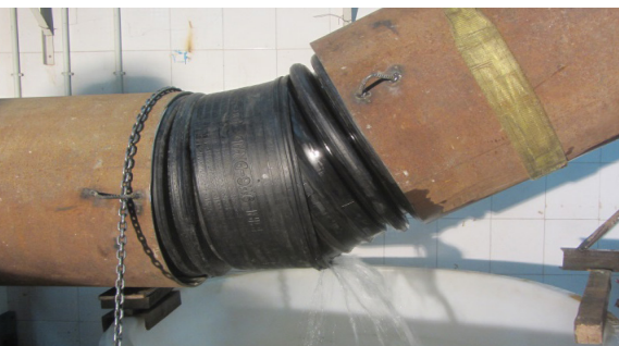
شکل ۲- چرخش اتصال نر و مادگی به‌همراه تغییر شکل‌ها و نشت سیال داخل لوله
