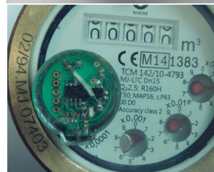
شکل ۱- نمایی از محل نصب پلمپ بر روی کنتور
