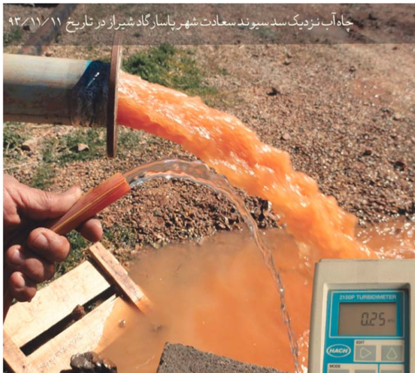
شکل ۴- مقایسه کدورت آب قبل و بعد از تصفیه
