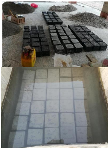
شکل ۱- محل تهیه آب خاکستری، مخزن عمل‌آوری و مصالح و تجهیزات مورد استفاده
