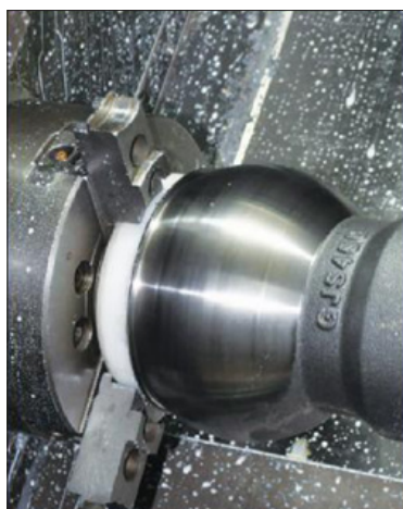
شکل ۲- مرحله ای از طراحی و ساخت تویی زانوی انعطاف پذیر
