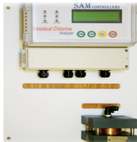
شکل ۱- نمای شماتیک از سیستم آنالایزر کلر آنلاین
