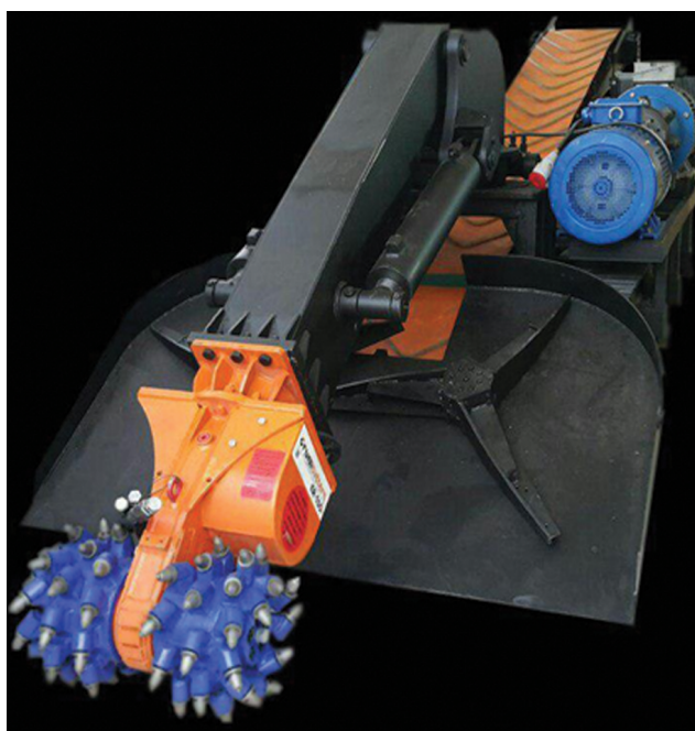
شکل ۱- دستگاه حفاری تونل‌های کوچک مقطع
