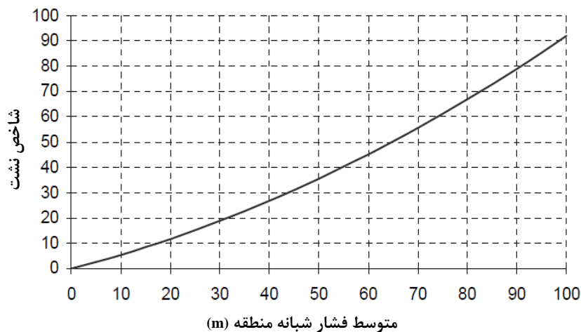
شکل ۲- رابطه بین متوسط فشار شبانه منطقه و شاخص نشت (نشریه شماره ۵۵۶، ۱۳۹۱)
