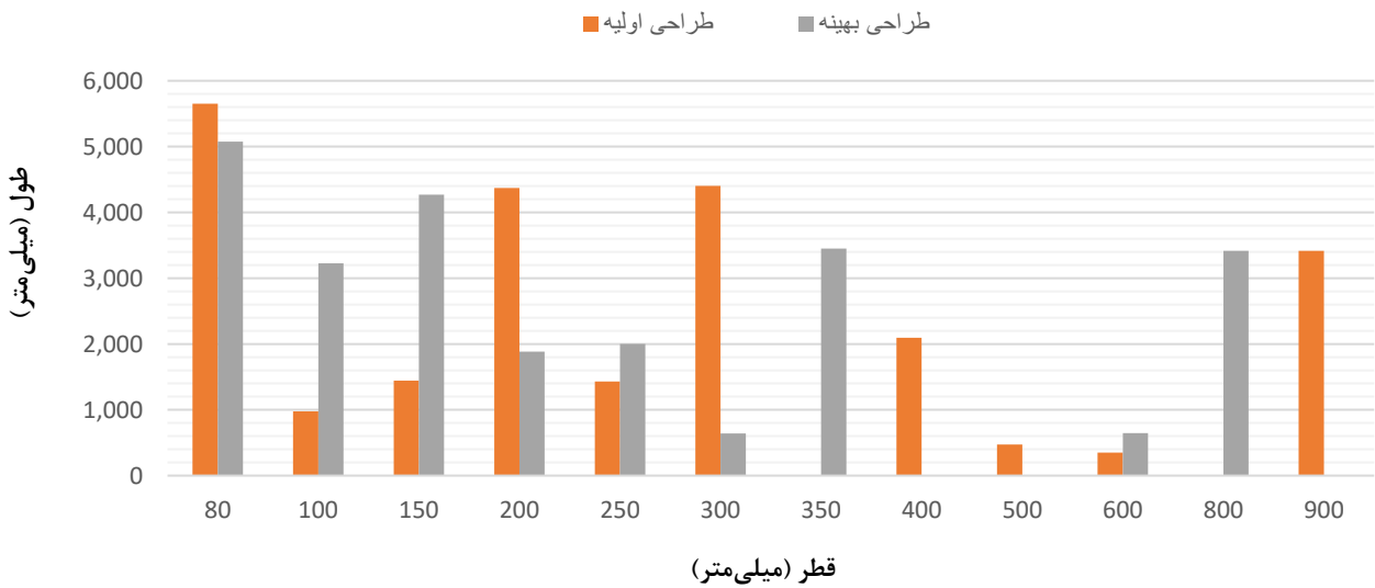
شکل ۳- مقایسه بین طول لوله‌های بکار رفته در طرح اولیه و طرح بهینه
